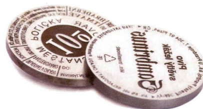
Obr. 4 Příklad laserového gravírování
