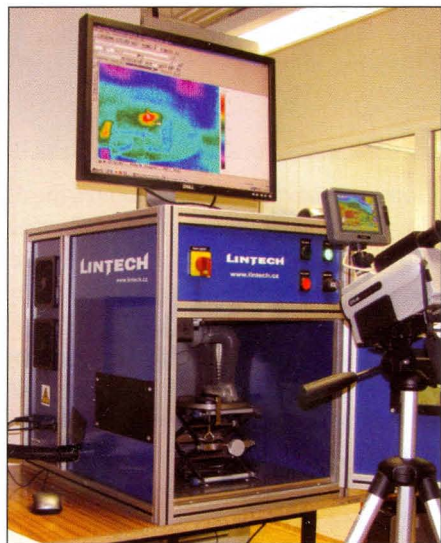
Obr. 1 Termovizní měření teplotního pole součásti při laserovém gravírování
